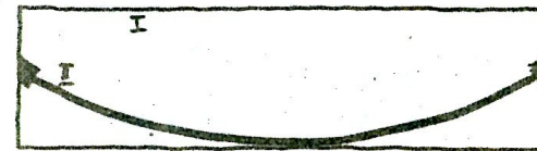
GRINDA DE BETON PRETENȚIONAT (COMPLEX I+II)
