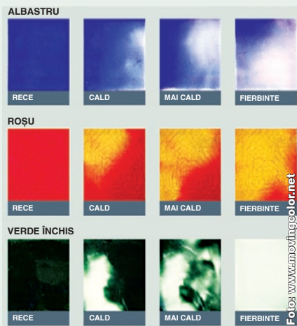
Plăci de sticlă termocromatică, seria „Watercolors™”, de la Moving Color®. Variațiile de culoare în funcție de modificarea temperaturii.
