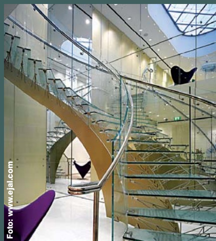
Scări circulare cu trepte din sticlă și structură metalică (vang central și tiranți). Arhitect Eva Jiricna Architects, 2008. Magazinul de bijuterii Boodles, Londra, Anglia. (Foto: Richard Bryant, Arcaid)
